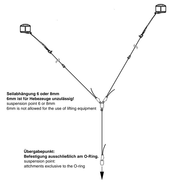
max. 100kg lotrecht max. Hängepunkthöhe 7,50m max 100kg perpendicular, max height 7.5m
